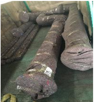
管组模块出厂前粘贴二维码并进行成品保护
