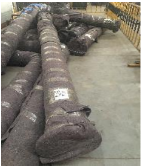
管组模块出厂前粘贴二维码并进行成品保护
