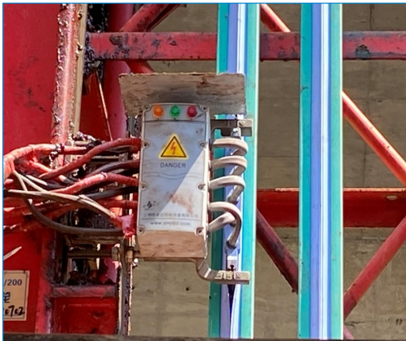
6、超高层室外施工电梯采用滑触线
