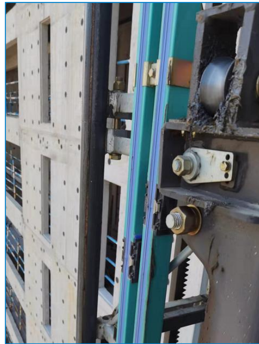
6、超高层室外施工电梯采用滑触线
