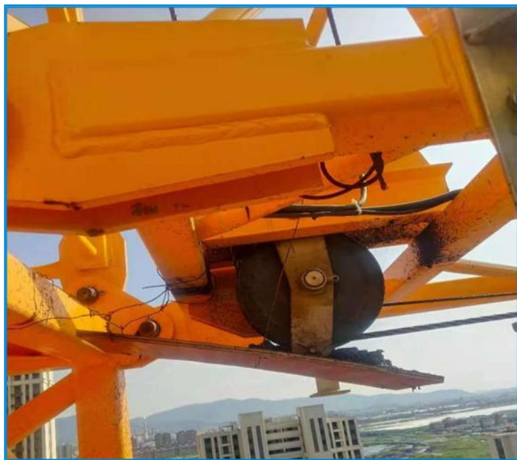
16、重量限制器接油板
