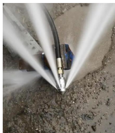
图 9.1.4-2 立管内部冲洗水枪
