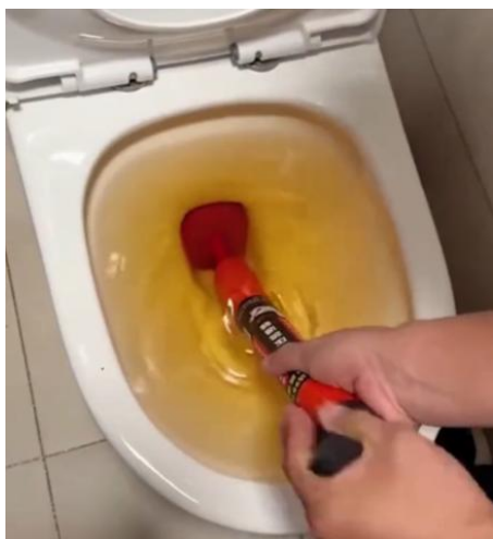
图 6.2.2-3 压缩空气式马桶搋子
