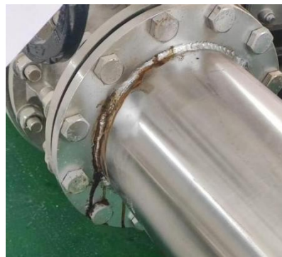
图 3.5.3-1 埋地管连接部位渗漏 图 3.5.3-2 不锈钢管焊接部位渗漏
