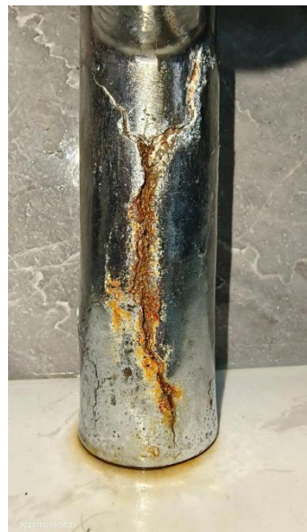
图 9.1.6-2 五金件氧化锈蚀
