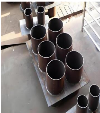
图 3.5.2-5 钢板止水穿墙套管群做法
