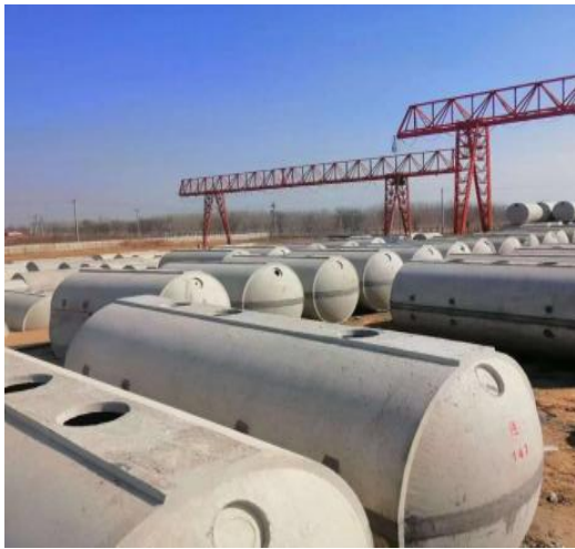
图 2.3.4-1 预制混凝土化粪池
