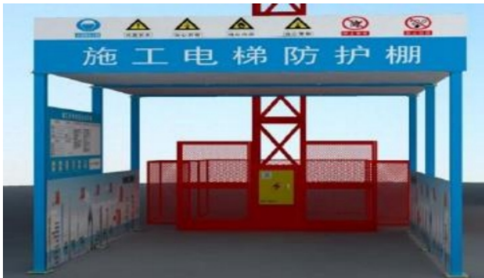
定型化安全通道（施工电梯防护棚）
