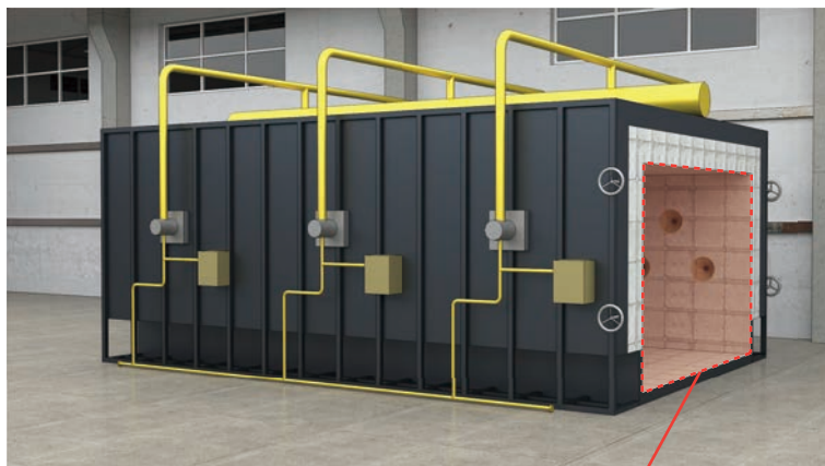
扩散燃烧方式的燃气窑炉外部
