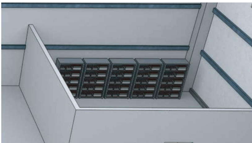
实体墙隔离的电池 ✓
