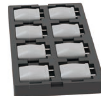
过充电电池-电压 \geq 4.7V ,通常胀气
