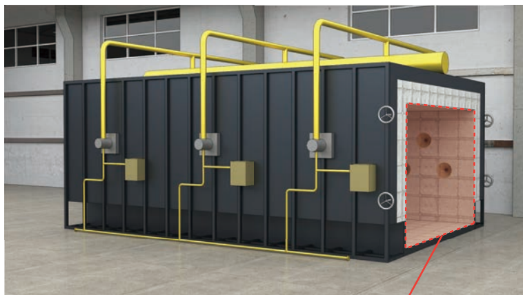
扩散燃烧方式的燃气窑炉外部
