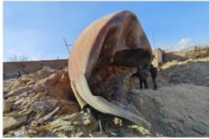
图8 1号球罐上部残片图
