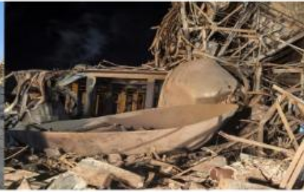
图9 1号球罐下部残片图
