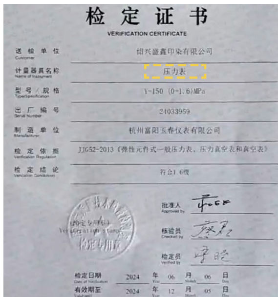
压力表定期校验并标明工作压力红线
