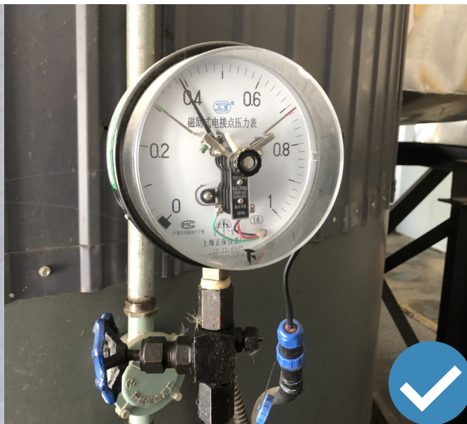
压力表定期校验并标明工作压力红线
