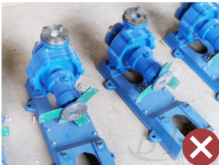
循环泵进出口未安装过滤器
