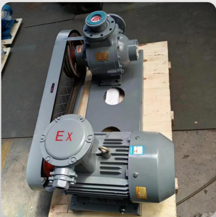
图示：液化石油气(LPG)专用烃泵设备
